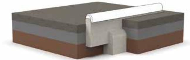
Betonwegeinfassungen mit Gummigranulatüberzug werden bodengleich eingebaut.
